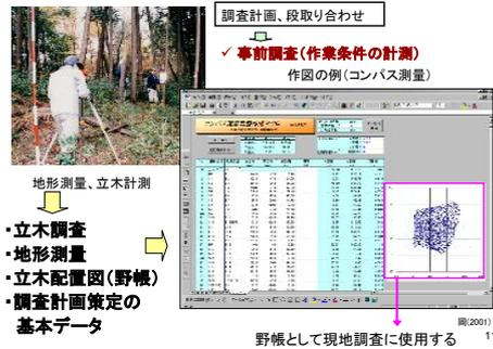
• ハーベスタ、フォワーダシステムによる列状間伐、点状間伐の生産性の把握を行うため、事業実施以前に行っている立木配置、地形測量などの予備調査の例(写真)。図は測量結果を図化したものであり、工期調査(本調査)の野帳として機械位置などの把握に使用。
