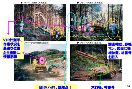
• ハーベスタ、フォワーダの主要作業として移動、伐木・造材(ハーベスタ)、積み込み、走行、荷おろし(フォワーダ)の調査風景である。
