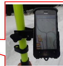
GNSSレシーバ等を活用した端末に境界情報を入力し簡易な杭打ち作業に活用
