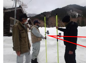
GNSSレシーバ等を活用した端末に境界情報を入力し簡易な杭打ち作業に活用
