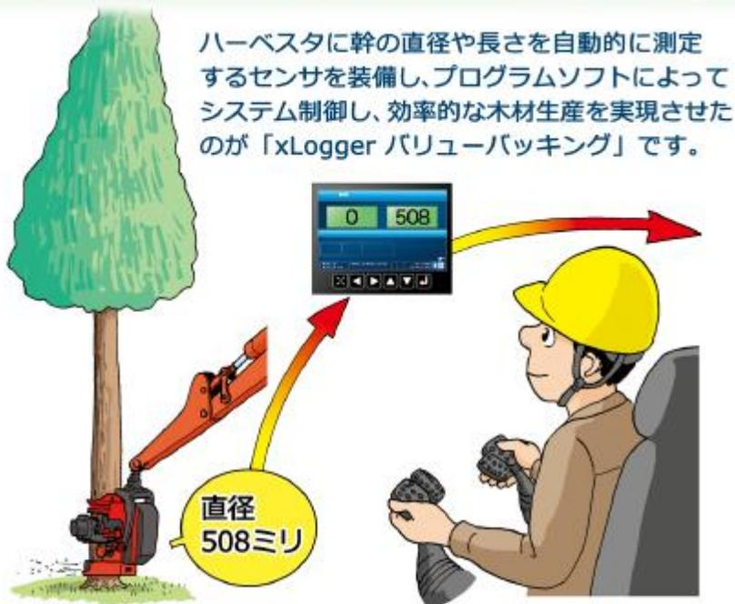
ハーベスタに幹の直径や長さを自動的に測定するセンサを装備し、プログラムソフトによってシステム制御し、効率的な木材生産を実現させたのが「xLogger バリュースタッキング」です。
