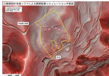
②搬出間伐事業地(約4ha)において、作業道(L=1,230m、W=3m)の設計を行い、合理的な施業の為の線形検討に活用した。作業道は並行して開設し、木材生産(スギ700m<sup>3</sup>)に着手した。
