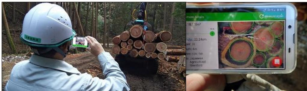
はい積みされた丸太の木口を撮影することで、自動で材積計算(末口二乗法)、長さ既知の対象物(ポール等)を同時に撮影する必要がある。
