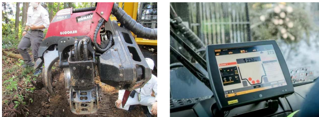
図 4-2 StanForD に対応した ICT ハーベスタ・ICT フォワーダの例
