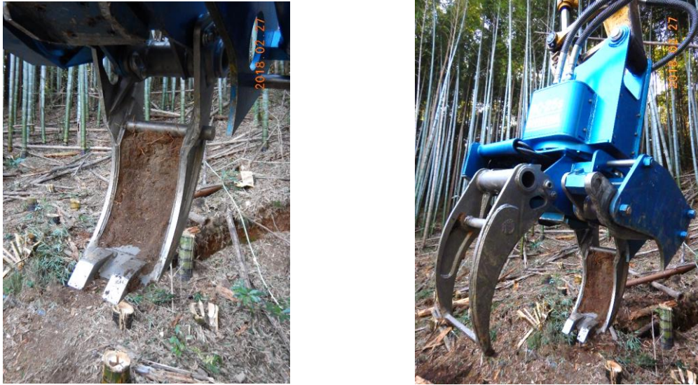
図 3.3 根茎処理効率化のためバケットに追加された2個の刃
