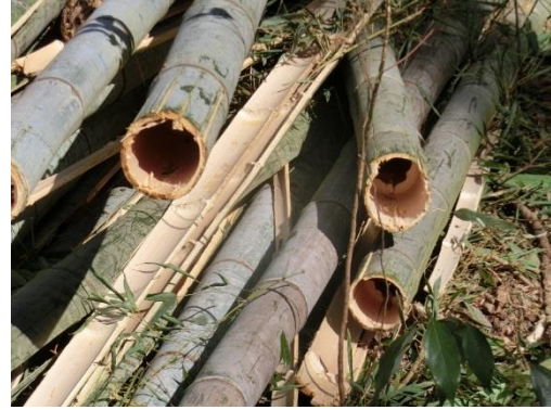
図 4.15 BC-25s で玉伐りした竹の切断面
