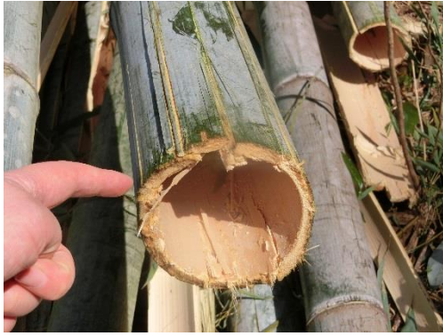
図 4.15 BC-25s で玉伐りした竹の切断面
