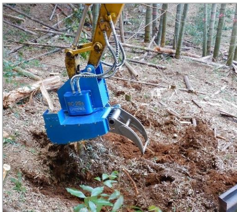
バケットの爪で根茎を切断
