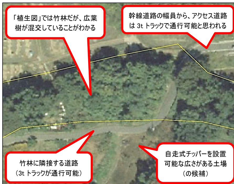
図 4.16 さらに拡大してアクセス道路や土場を確認
