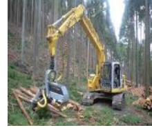
大型高性能林業機械 による主伐や地拵
