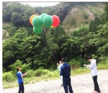
写真 バルーンによる上空の電波強度測定
