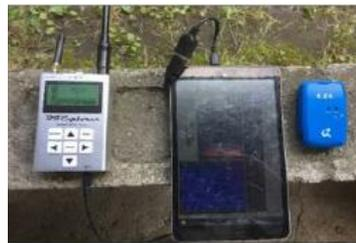
写真 電波受信機・タブレット型PC・GNSS
